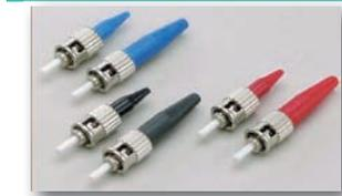
El **conector ST** (*Straight Tip*) es un conector semejante al SC pero requiere un giro del conector para la inserción del mismo, de modo semejante a los conectores coaxiales. Suele utilizarse en instalaciones Ethernet híbridas entre cables de pares y fibra óptica. Como en el caso del conector SC, también se requiere el pulido y la alineación de la fibra.
