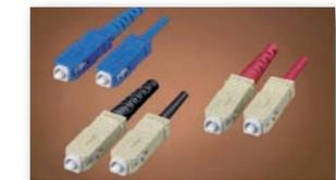
El **conector SC** (*Straight Connection*) es un conector de inserción directa. Suele utilizarse en conmutadores Ethernet de tipo Gigabit. La conexión de la fibra óptica al conector requiere el pulido de la fibra y la alineación de la fibra con el conector.
