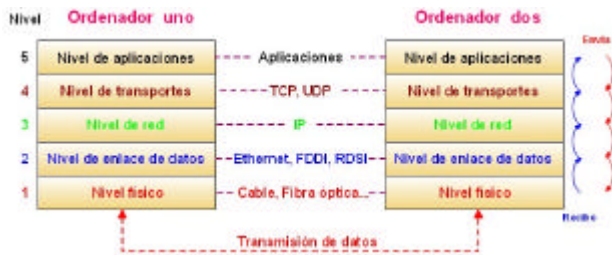
Modelo de capas simplificado para TCP/IP
