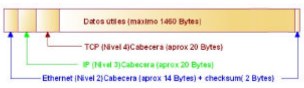
Paquete TCP/IP sobre Ethernet
