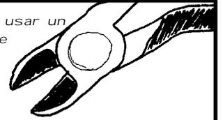
coloca el filo plano abajo, paralelo al PCB, en la parte superior de la gota de soldadura. aprieta la empuñadura y el filo cortará de golpe.
