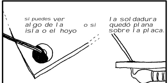
si hay demasiada soldadura eso quiere decir que agregaste tanto estaño que hay una gota de soldadura sobre la isla suficientemente grande como para tocar otra isla, creando una conexión donde no debería haber una. esto puede pasar.
