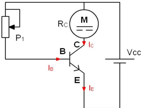
Control de velocidad de un motor
