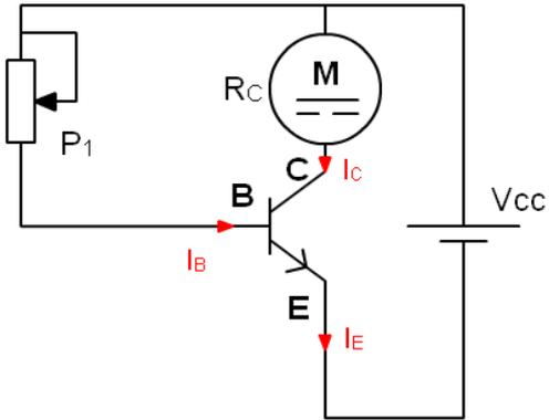
10.- Si en el circuito anterior tenemos un motor de 9V, 50 mA, la  $\beta$  del transistor es de 50, la  $V_{BE} = 0,6V$ , la  $V_{CE} = 0,2V$ ,  $V_{CC} = 9V$ . ¿Cuál debe ser la corriente de base para que el motor funcione con normalidad? ¿En qué valor de  $P_1$  se dará esta corriente?
