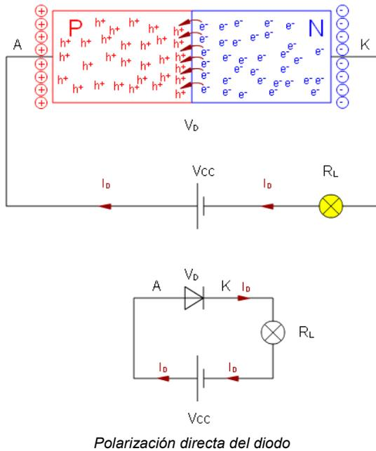
Al aplicar tensión directa, se reduce la barrera de potencial de la unión, debido a la polarización de la batería, que impulsa a los electrones ( $e^-$ ) de N y huecos ( $h^+$ ) de P. Por tanto, los electrones ( $e^-$ ) tienden a cruzar la unión de N a P y los huecos ( $h^+$ ) en sentido opuesto.
