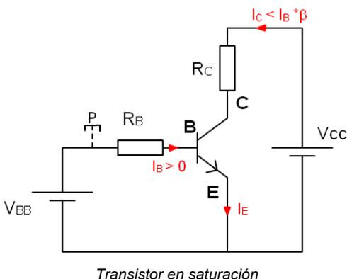
Cuando hacemos trabajar a un **transistor en corte-saturación** su comportamiento es como el de un **interruptor electrónico**.
