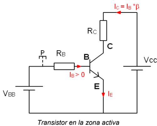
Decimos que **el transistor está en saturación** cuando la corriente que circula por el colector cumple,  $I_C < I_B * \beta$ . La saturación se consigue si el valor de  $I_C$  es menor al calculado en la zona activa.
