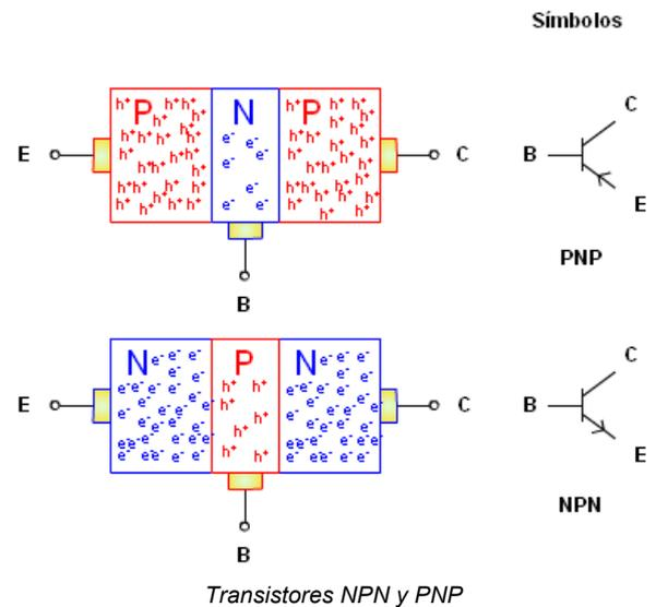
El transistor consta de tres terminales llamados: emisor (E), base (B) y colector (C). A la base le corresponde la región central, de espesor muy pequeño y escaso dopado.
