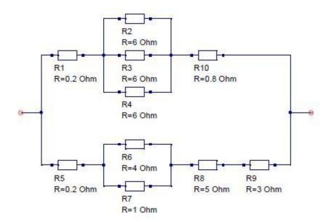
Calcular la resistencia reducida del circuito que indica el esquema.
